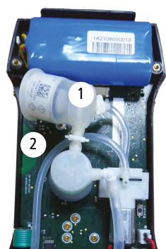
Cappuccio in gomma bianca con sensore rimosso
