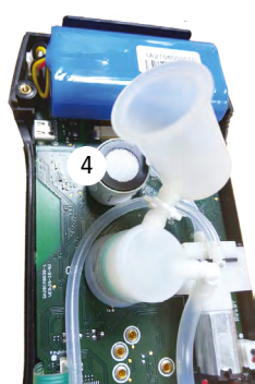
Nuovo sensore connesso alla scheda elettronica
