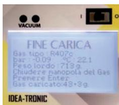
Foto 3: Dopo ogni carica parziale attendere la compensazione delle pressioni, fino al raggiungimento della carica completa
