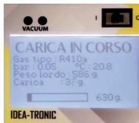
Foto 3: Controllare l'avanzamento della carica sul display. Al termine della carica chiudere il rubinetto.
