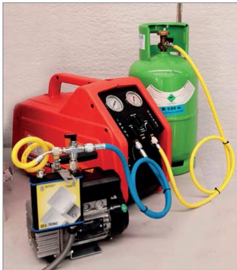
Qualora sia necessario fare il recupero di refrigerante del sistema da riparare, occorre utilizzare una connessione a 3 vie, fornita come optional (foto 2) che collega simultaneamente IDEA.X, il recuperatore e la pompa vuota.
