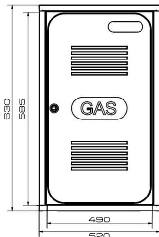
Cassetta per contatori gas con sportello in vetroresina trattato anti-UV, telaio e struttura in lamiera inox AISI 304; progettata per l'alloggiamento di gruppi di misura del gas con portata volumetrica fino a 6 m<sup>3</sup>/h.
